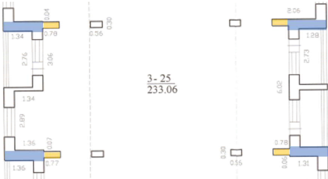
13 pav. Kiemo korpuso 3 aukšto salės skaičiuojamų mūro fragmentų matmenys
